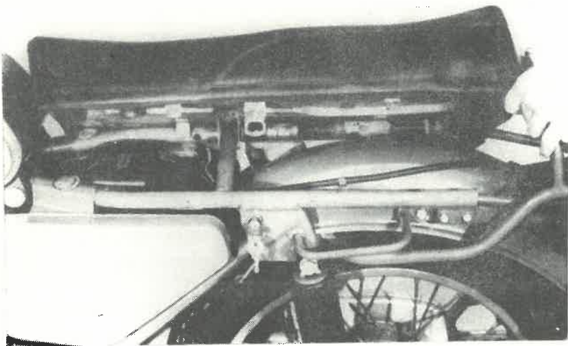
44. Demontáž sedla a vyjmutí zámku
