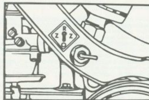
Obr. 4 Palivový kohút O — prívod paliva otvorený Z — prívod paliva zatvorený R — otvorená rezerva
